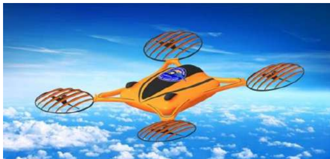
БАГАТОМОТОРНИЙ БЕЗПІЛОТНИЙ ВЕРТОЛІТ ДЛЯ ПЕРЕВЕЗЕННЯ ВАНТАЖІВ ПКМ-14 «САТУРНІЯ»
